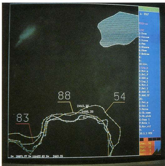
*Dettaglio delle variazioni frontali della Vedretta del Mandròn; restituzione computerizzata sulla base di foto aeree curata dalla FM Endaco srl di Lavis.*
